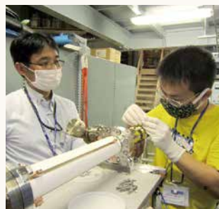
高速ビームキッカーの組み立て作業の様子
