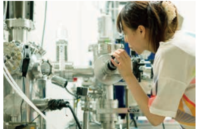
X線光電子分光による物性解析 不安定化合物のX線光電子分光による物質の電子状態解析と物性評価
